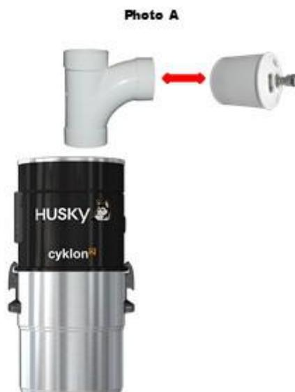
Il peut être positionné horizontalement ou verticalement. Le Vac-Valve doit être réglé par rapport à la puissance (dépression) du moteur afin qu'il fournisse la protection appropriée. Pour régler la vanne Vac, serrez l'écrou N° 1 **photo B ci-dessous**, pour comprimer le ressort, de manière à ce que la valve ne s'ouvre pas lorsque le flux d'air est de 100 %.
